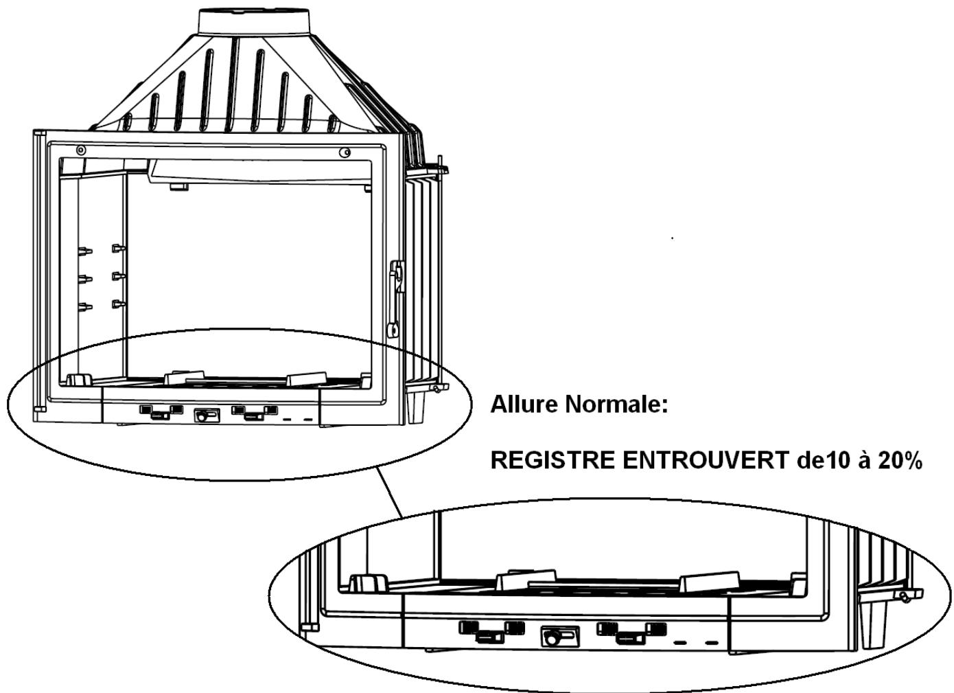
**Quel que soit le mode de fonctionnement désiré (Puissance nominale ou Combustion prolongée), s'assurer que chaque charge de bois s'allume dès son introduction dans l'appareil et que l'inflammation se maintient. Dans le cas contraire, rouvrir quelques instants le « registre de réglage d'allure » en position « allumage » jusqu'à obtenir un embrasement satisfaisant du bois :**
